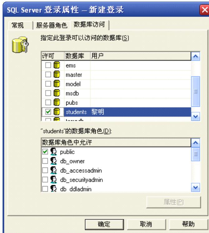
选择完成后，单击确定按钮，在出现的密码确认对话框中，再次输入密码并按确定按钮，就建立了新的登录用户。
